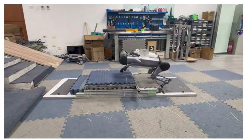
轨迹规划：质心轨迹规划器根据当前质心状态和控制输入指令计算得出目标位置和速度；足端轨迹规划器用于计算足端位置、速度和腿部相位
