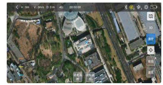
机身内置高清摄像头采集周边环境图像，采用无线宽带技术将图像信息回传到终端APP，在手机端上实现扑翼飞行图像的查看功能。
