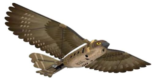
内置核心处理器、陀螺仪、气压计等高端芯片和传感器等，实时监测多种传感器的数据，并计算分析扑翼飞行器的飞行姿态，实现飞行姿态的自主闭环控制，从而实现定高飞行、直线飞行、转弯、爬升、俯冲等动作等。
